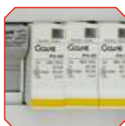
Protector de sobretensiones Protector de sobretensiones Clase II. Conexión superior de las fases e inferior de la tierra. Indicación visual de final de vida.
